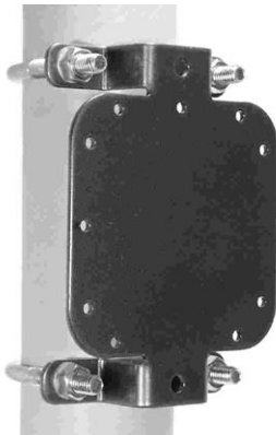
Rohr-Montage Kit Typ A-610 Maße: 110 x 100 mm Rohr: Ø 40-65 mm Material: Stahl, lackiert
